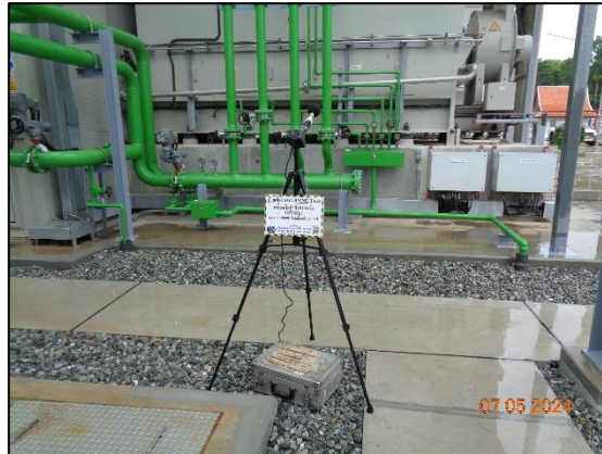
รูปที่ 3.16 การตรวจวัดระดับเสียงในพื้นที่ทำงาน บริเวณ Gas Turbine Generator
