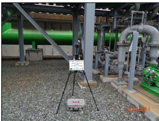
รูปที่ 3.18 การตรวจวัดระดับเสียงในพื้นที่ทำงาน บริเวณ Cooling Tower
