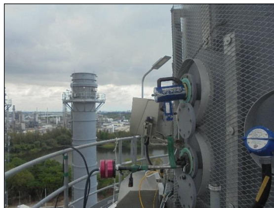
รูปที่ 3.1 การเก็บตัวอย่างคุณภาพอากาศในปล่องระบาย บริเวณ HRSG11
