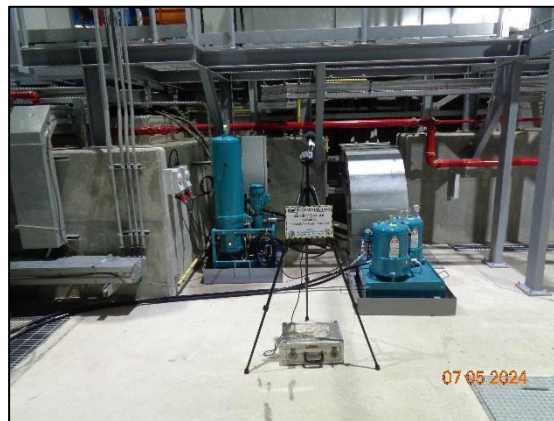
รูปที่ 3.17 การตรวจวัดระดับเสียงในพื้นที่ทำงาน บริเวณ Steam Turbine Generator
